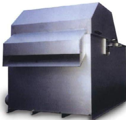
Il sistema sarà costituito da più coppie di dischi di filtraggio calettati su un albero ancorato ad un telaio. La frazione solida verrà scaricata automaticamente dall'interno della macchina dalla stessa rotazione dei dischi filtranti e raccolta nel cassone individuato in planimetria con la sigla CFS1.
