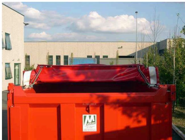
Come si evince dalle suddette immagini si tratta di un cassone dotato di copertura azionabile da un sistema a scorrimento. La copertura si raccoglie in un minimo spazio e nella sua completa estensione aderisce perfettamente all'allestimento, garantendone la totale copertura.
